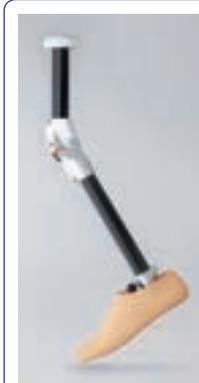
ロック状態で義足を振り出すと、任意の設定範囲(5~30度)で膝継手が遊動します。遊脚相初期から中期にかけて膝継手が軽度屈曲することで、床面との間のトゥ・クリアランスを確保し、義足足部のつま先が床に引っかかるのを防止します。伸び上がり歩行や、
