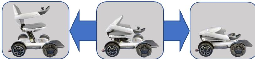
操作ボックス部の速度切替スイッチとブザースイッチの同時長押しにより、折り畳みから展開が可能。(ブザースイッチと⊕→展開) (ブザースイッチと⊖→折りたたみ)
