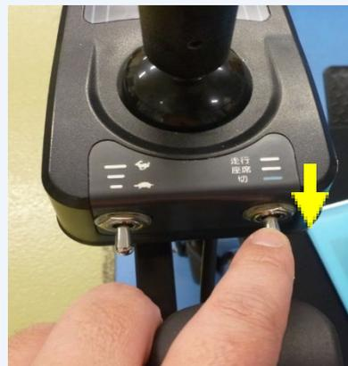
操作ボックスの電源スイッチを「切」に合わせます。
