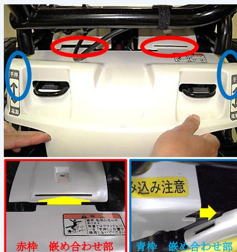
背面カバーを外した時と逆の手順で本体に嵌め込みます。この時、本体の凹とカバーの凸を嵌め合わせてください(4箇所：詳細は次ページ)。
