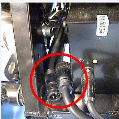
コネクタの接続を外したら、バッテリー線の端子部分が、それぞれ接触しない状態にし、元の場所に押し込みます。
