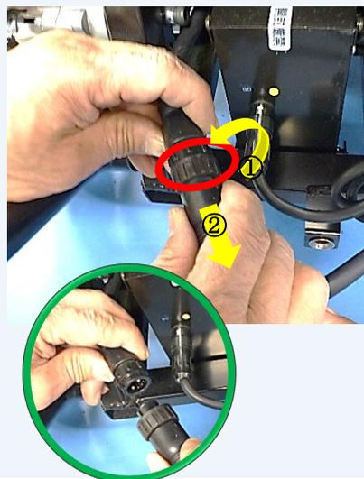
コネクタ部の中央部分を左方向に回してコネクタ接続を外します。コネクタ部を回すときはネジ部分が完全に外れるまで回してください。
