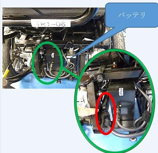
カバーを完全に取り外し、径の一番太い線(バッテリー線)を引っ張り出します。(中央に配置されたボックスの右側がバッテリーです)
