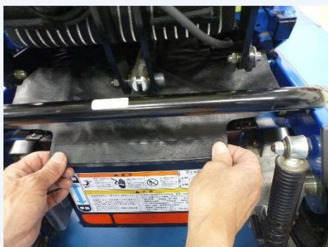
背面のバッテリーケース上部のビニールカバーのマジックテープをもとに戻して完了
