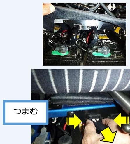
カバーを開けると、バッテリーがあります。背面から覗き込みバッテリーの上にあるコネクタ挿し込み口の2本のコネクタをコネクタ左右のロックをつまみながら手前に引き抜きます。
