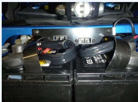
外した2本のコネクタをバッテリー上部の隙間に入れ込んで、なるべく動かないようにします。
