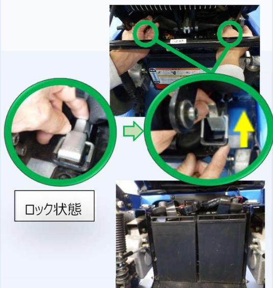
背面のバッテリーケース上部のビニールカバーのマジックテープをはがし、カバープレートのロック錠を上側に回転させ引き上げるとロックが外れます。ロックが外れた状態で、カバープレートを手前に引いてカバーを開けます。
