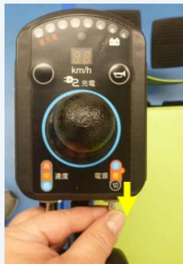
操作ボックスの電源スイッチを「切」に合わせます。
