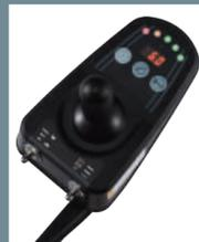
操作ボックスの切り替えスイッチにより、走行から座席の角度調整まで全ての操作がレバー1本で思いのまま。たとえば角度調整時には、操作レバーを左右に倒すことにより「リクライニング」・「ティルト」の切り替えができ、前後に倒すと可動します。表示パネルは選択速度・リクライニング・ティルトをデジタル表示。バッテリー残量メータは、高輝度LEDを使用し見やすくなりました。また、照度センサーにより周囲の明るさに合わせて表示が見やすいようにLEDの明るさを自動で切り替えます。
